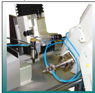
Lackierbasiseinheit mit 6-Achsen-Knickarmroboter
